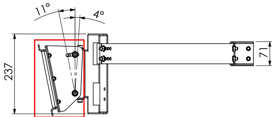
Support SCR1 ou 2 en fonction des besoins du client
